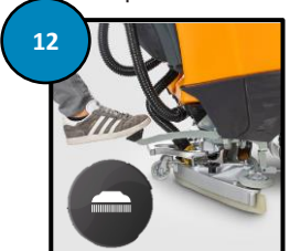
12 Løft børstedekket med pedal eller bryter.
